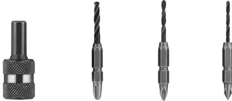
Il kit, fornito in blister, è composto di un piccolo mandrino con ghiera di bloccaggio scorrevole ed attacco esagonale da 3/8" da inserire nel mandrino dell'elettrotensile e di tre inserti a croce differenti nei quali sono saldate tre punte a forare di diametro 2,5 - 3 e 4 mm.
