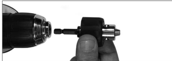
**2.** Nel mandrino senza chiave con chiusura manuale inserire una punta a forare sino a 7 mm di diametro
